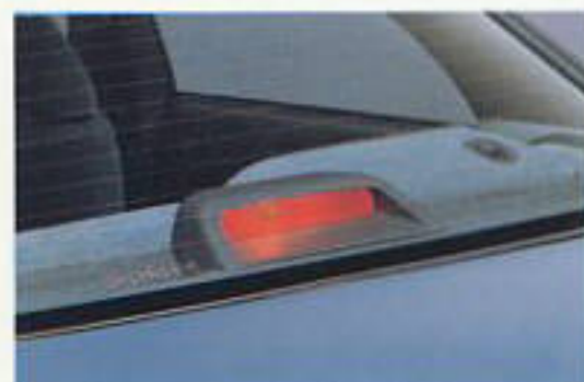
バルブ式ハイマウントストップランプ(室内装着タイプ)
