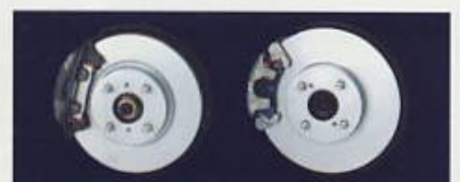
(左)フロントベンチレーテッドディスクブレーキ (右)リヤディスクブレーキ
